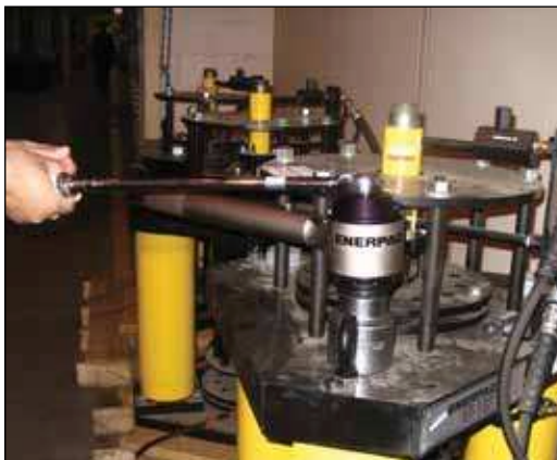
◀ Multiplicador de par con barra de reacción E393 de Enerpac utilizado para apretar a mano pernos con un par de hasta 4300 Nm.
