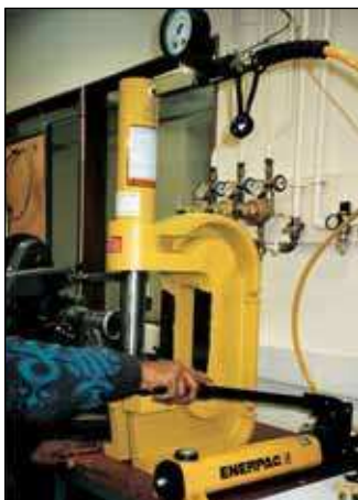
◀ A-310 Prensa de mandrinar para árboles, utilizada para compactar polvo a 10 toneladas.
