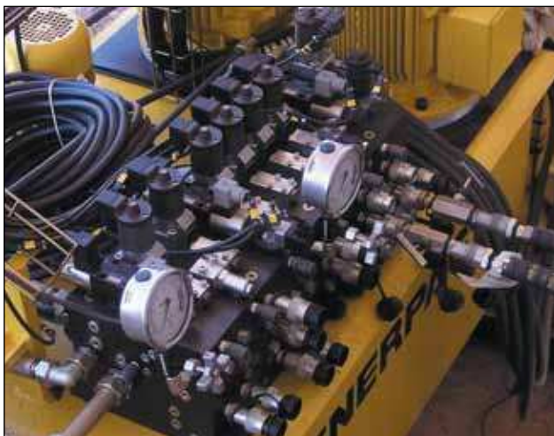
◀ Control de varios cilindros con electroválvulas direccionales.
